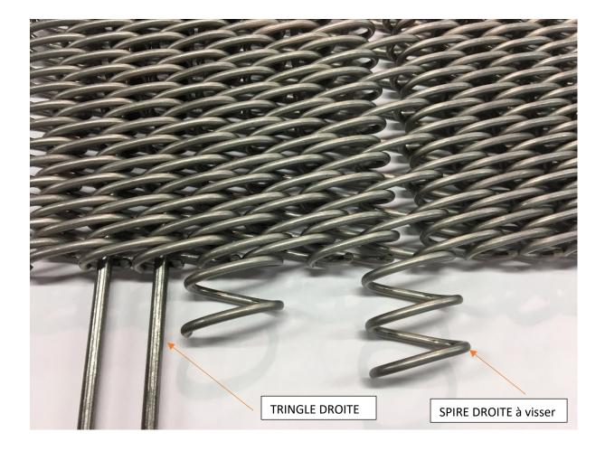
Le tapis de type INTERBANDE DOUBLE se compose de spires vissées les unes dans les autres. Les spires sont ici doublées. Le raccordement se fait par vissage de deux spires, à disposer en deux temps. Deux tringles droites sont ensuite à insérer dans ses deux spires, afin d'obtenir une jonction sans fin. Ces tringles sont ensuite généralement à souder, comme sur le reste du tapis.
