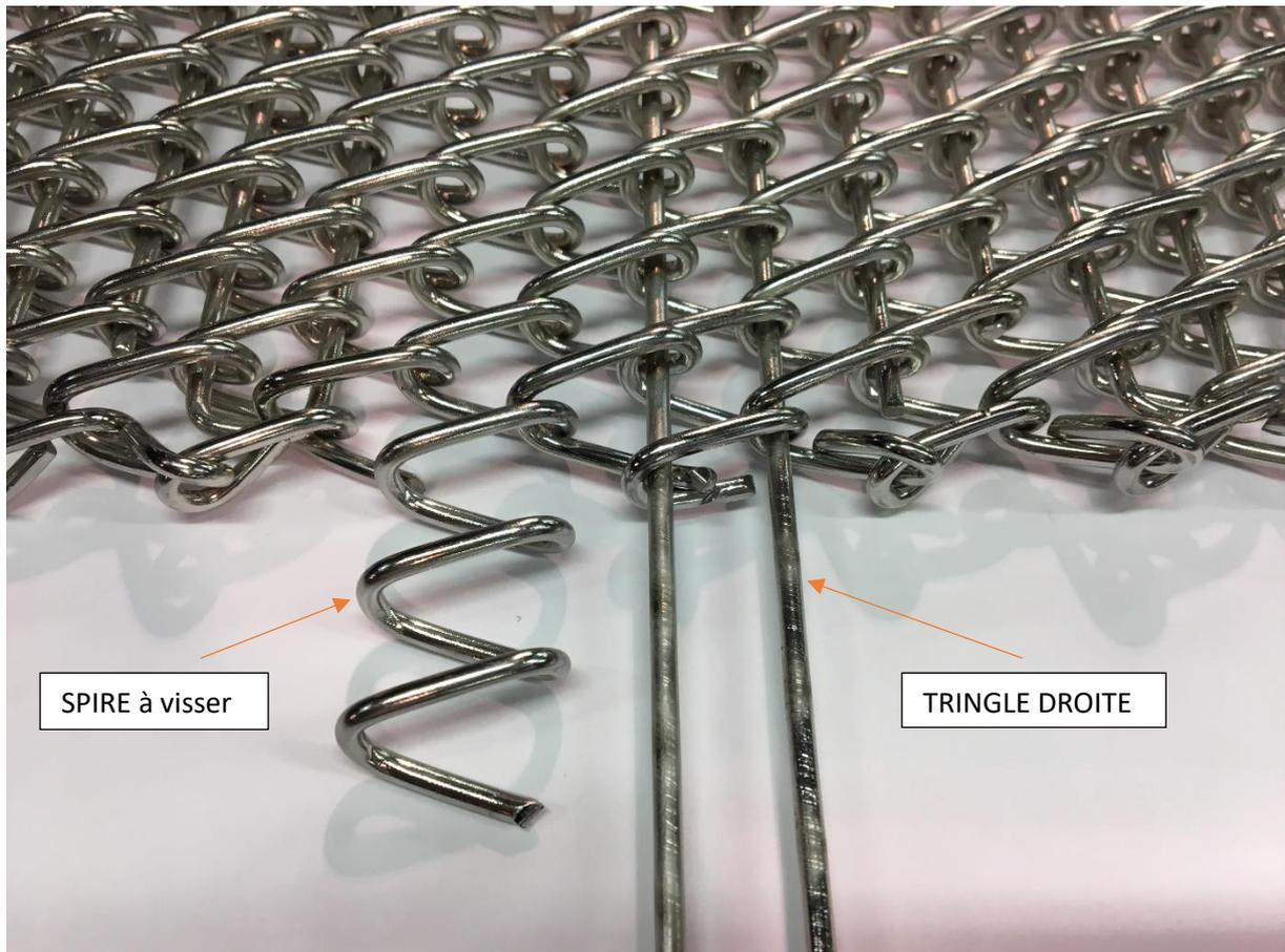
Le tapis de type INTERBANDE est composé de spires vissées les unes dans les autres. A sa fermeture, il faut rapprocher les deux bords du tapis et raccorder en vissant une spire sur toute la largeur du tapis. Placez ensuite la tringle droite, qui passe par le nœud formé par la jonction de deux spires. Bouclez ou soudez ensuite les fils de spires au niveau des rives latérales.
