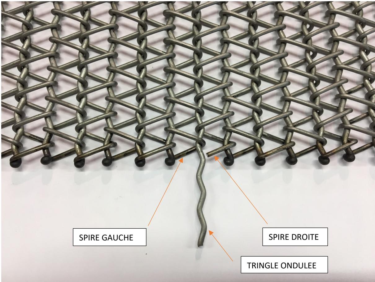
Le tapis de type ONDUBANDE est composé alternativement de spires droites et gauches. Le raccordement se fait par la jonction d'une spire droite et d'une spire gauche à l'aide d'une tringle ondulée. La tringle sera en générale soudée en rive sur la spire.
