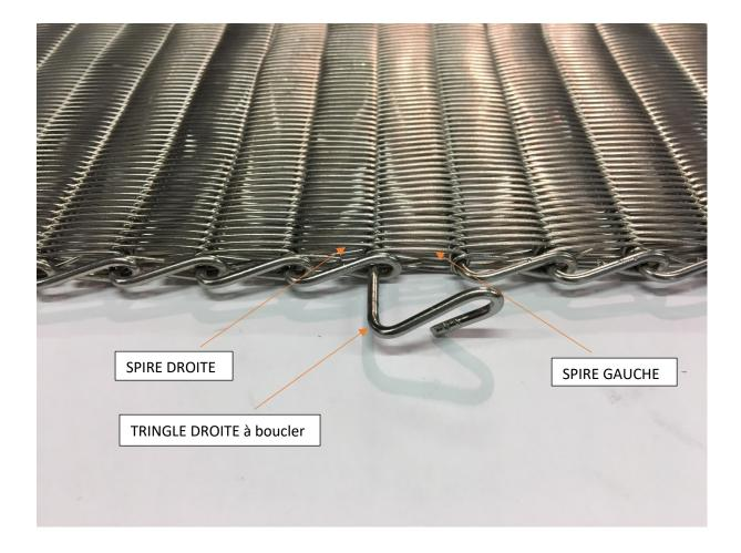
Le tapis de type RECTIBANDE est composé alternativement d'une spire droite et d'une spire gauche. Veillez à refermer le tapis en mettant en vis-à-vis, une spire gauche et une spire droite. Faire ensuite passer une tringle droite au travers de ces deux spires. Cette tringle droite sera ensuite bouclée à la pince, comme vu ici, ou soudée dans le cas d'une finition autre que bouclée.
