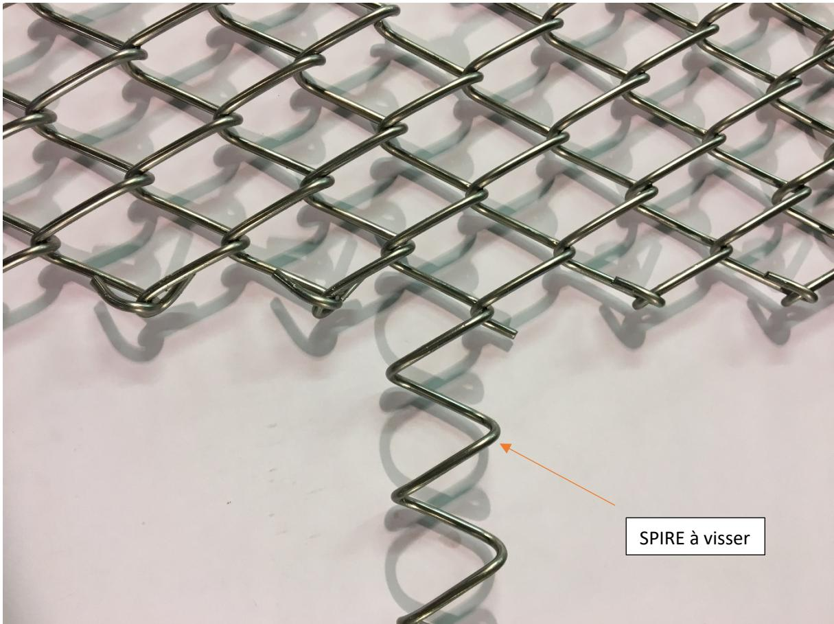
Le tapis de type SPIRABANDE se compose de spires vissées les unes dans les autres. Il faut rapprocher les deux bords du tapis, afin de visser une spire pour réaliser sa jonction. Le fil de cette spire est ensuite à boucler sur les deux rives du tapis, ou à souder pour un autre type de finition.
